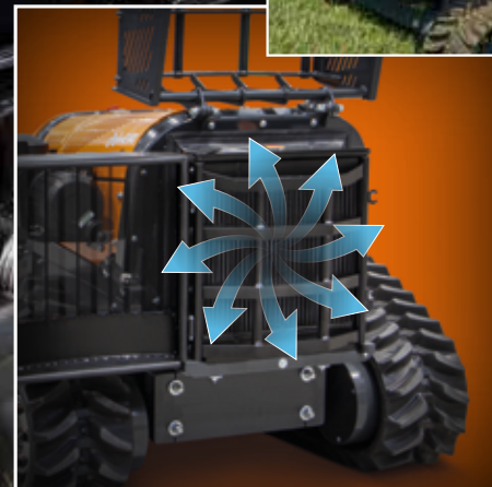
САМООЧИЩАЮЩИЙСЯ РЕВЕРСИВНЫЙ ВЕНТИЛЯТОР FREXXAIRE® SELF-CLEANING REVERSIBLE FAN
