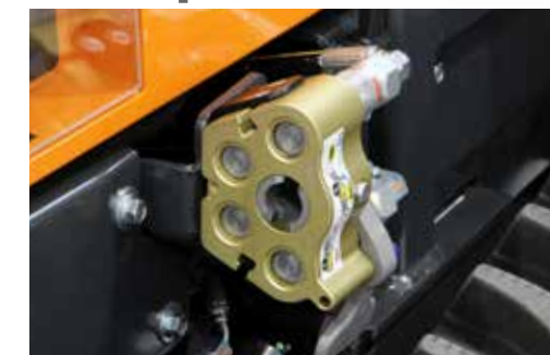
Быстрые гидравлические соединения (CEJN) CEJN fast hydraulic couplings
