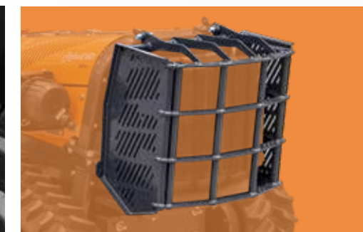
Стальная защита радиатора Steel radiator protection
